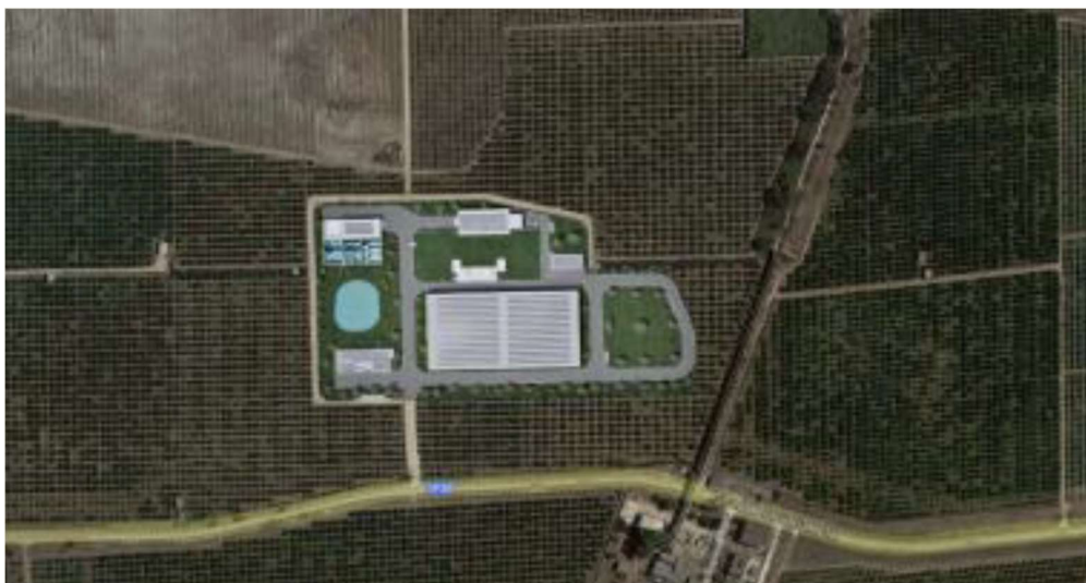
Fig 8b Individuazione delle opere fuori terra su planimetrie tematiche e del costruito inserito nel contesto agricolo attuale: impianto di dissalazione per osmosi inversa, rilancio acque dissalate, rilancio scarico, magazzini, uffici (elab SN-SUB)
